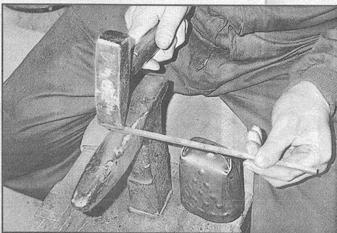
El esquilero de Mora, Antonio Sanmartín, fabricando un esquila; en las fotos se ve cómo modela la chapa, el esquila casi hecho y el proceso del arcillado
